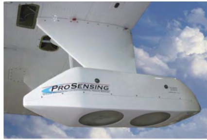
图 9 95 GHz 云雷达搭载在 CIRRAS Twin Otter 的飞机机翼
