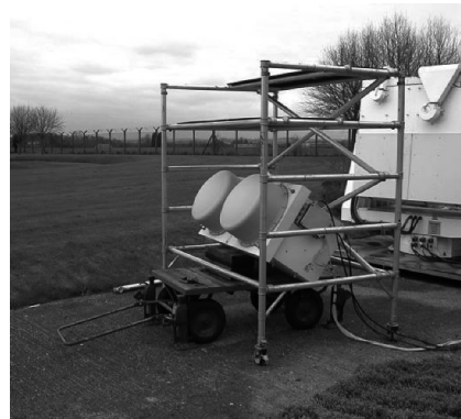
图 1 2002 年 3 月 14 号 Galileo 雷达的定标情况,其抬升角为 30°,脚手架避免雨水对毫米波雷达天线罩的影响
